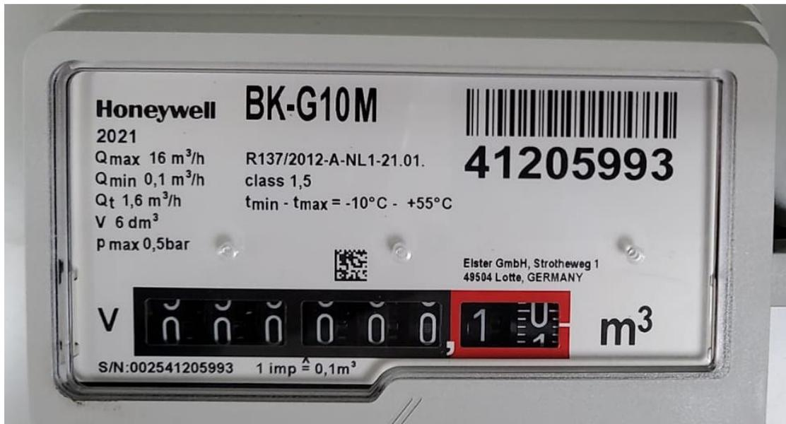
Fotografía 4. Vista de la placa de características del medidor de gas tipo diafragma, tamaño G10
