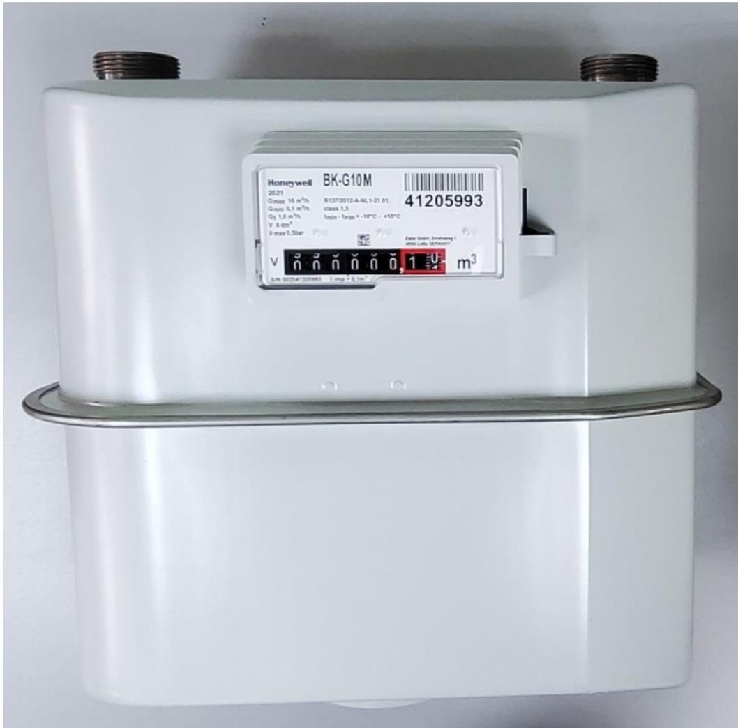
Fotografía 5. Vista frontal del medidor de gas entero tipo diafragma, tamaño G10
