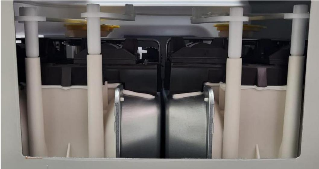
Fotografía 12. Vista frontal del medidor de gas cortado tipo diafragma, tamaño G25
