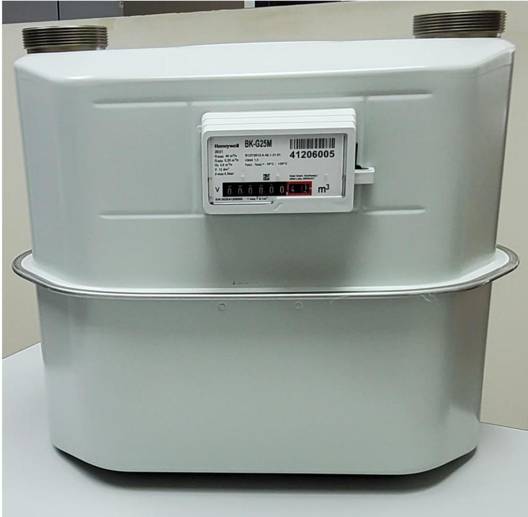
Fotografía 11. Vista frontal del medidor de gas entero tipo diafragma, tamaño G25
