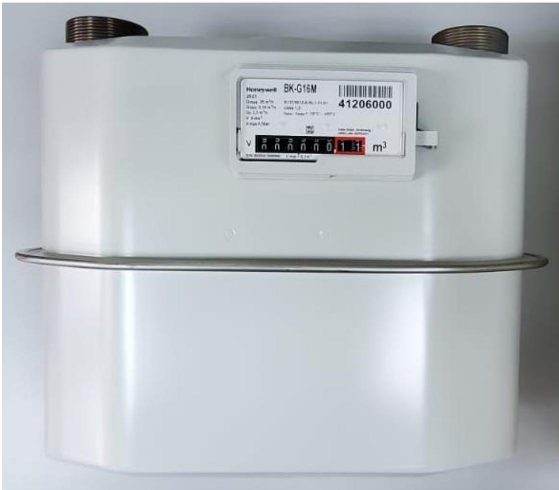
Fotografía 8. Vista frontal del medidor de gas entero tipo diafragma, tamaño G16
