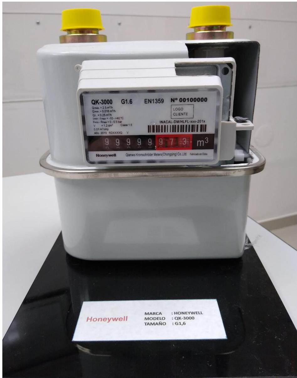
Fotografía 6. Vista frontal de la muestra cortada del medidor de gas marca Honeywell, modelo QK-3000, tamaño G1,6
