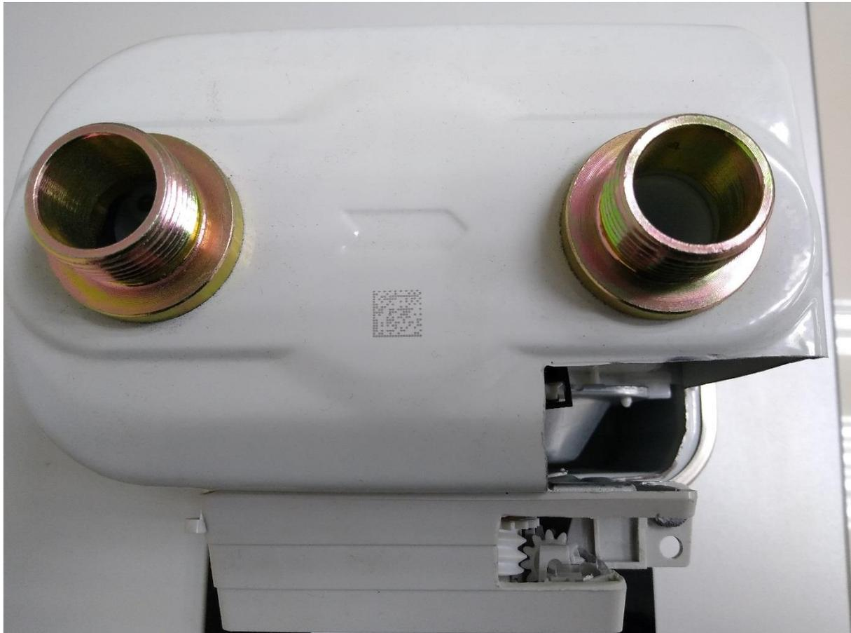
**Fotografía 8. Vista superior de la muestra cortada del medidor de gas marca Honeywell, modelo QK-3000, tamaño G1,6**
