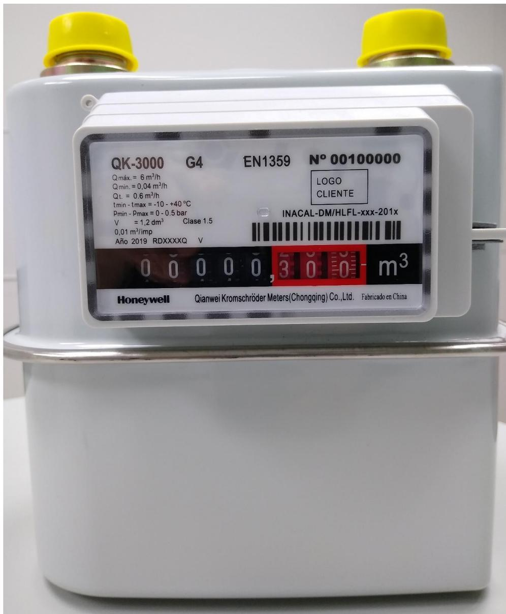
**Fotografía 2. Vista frontal de la muestra entera del medidor de gas marca Honeywell, modelo QK-3000, tamaño G4**
