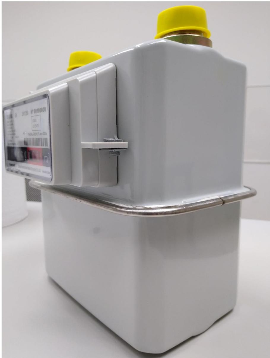
**Fotografía 3. Vista diagonal de la muestra entera del medidor de gas marca Honeywell, modelo QK-3000, tamaño G4**
