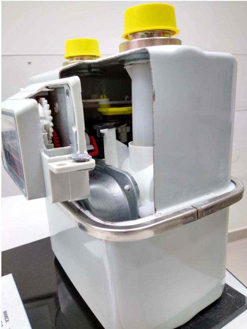
**Fotografía 7. Vista diagonal de la muestra cortada del medidor de gas marca Honeywell, modelo QK-3000, tamaño G1,6**
