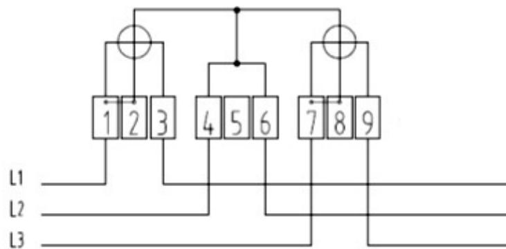
**Diagrama de conexiones (3F3H)**
