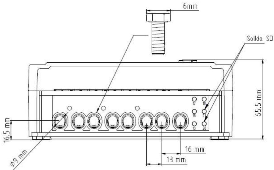
**Nota:** Cada una de las borneras cuenta con 2 tornillos de ajuste para el ingreso de los conductores
